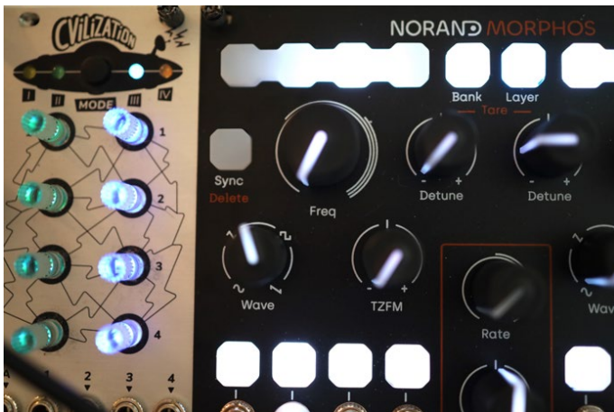
Ein Preset-Strip erlaubt auch Morphing zwischen Presets und deren Parametern – auch auf mehreren Ebenen und Dimensionen und auch via X, Y und Z CV Ins.
