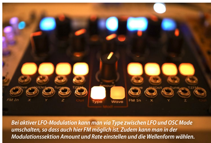
Norand Morphos. Rote Modulationstaster signalisieren eine LFO Modulation, grüne erlauben das Triggern einer Hüllkurve mit einstellbarem Decay und Amount. Der weiße Morph Strip erlaubt 3D_Morphing zwischen Oszillatorpresets.
