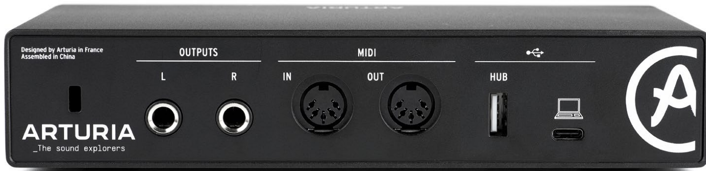
Neben den beiden Hauptausgängen im 6,3-mm-Klappenformat, verfügt das MiniFuse 2 über MIDI In/Out sowie gleich zwei USB-Buchsen. Der USB-C-Anschluss ganz rechts ist für die Verbindung mit dem Rechner gedacht, der USB-A-Anschluss links daneben gestattet den Anschluss weiterer USB-Geräte, beispielsweise eines Hardware-Controllers.
