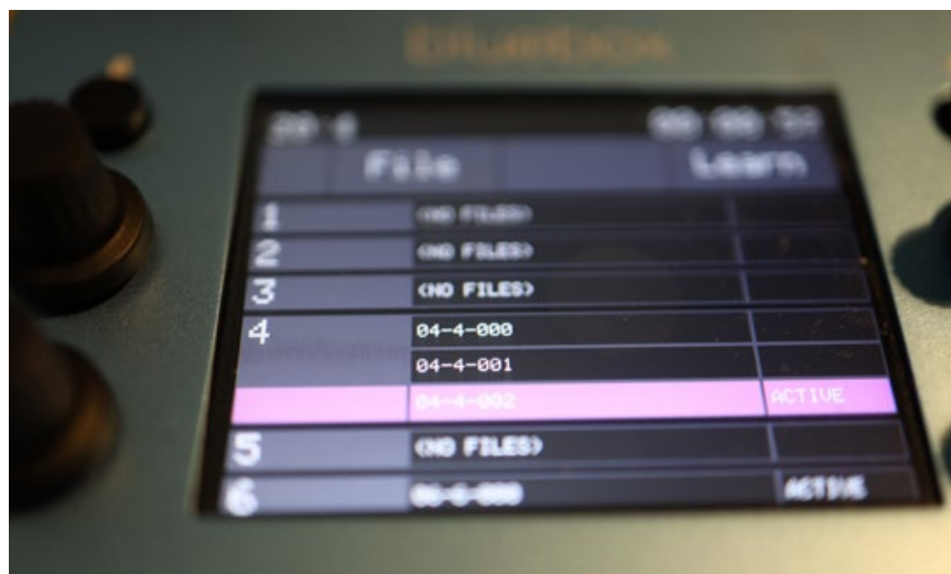
Der Multitrack-Recorder listet aufgenommene Files pro Spur auf, nur eines kann dabei aktiv sein
