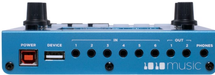
Rückseitig sind sechs Stereo-Inputs sowie zwei Stereo und Phones Outs zu finden. Außerdem ein USB-A-Out zum Anschluss eines Controllers und ein USB-B-In für die Stromversorgung
