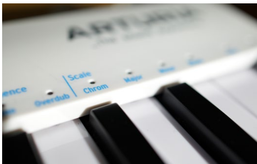
Via Shift+Scale kann man Skalenquantisierung aktivieren, unten auf dem Keyboard wird die Root Note eingestellt.
