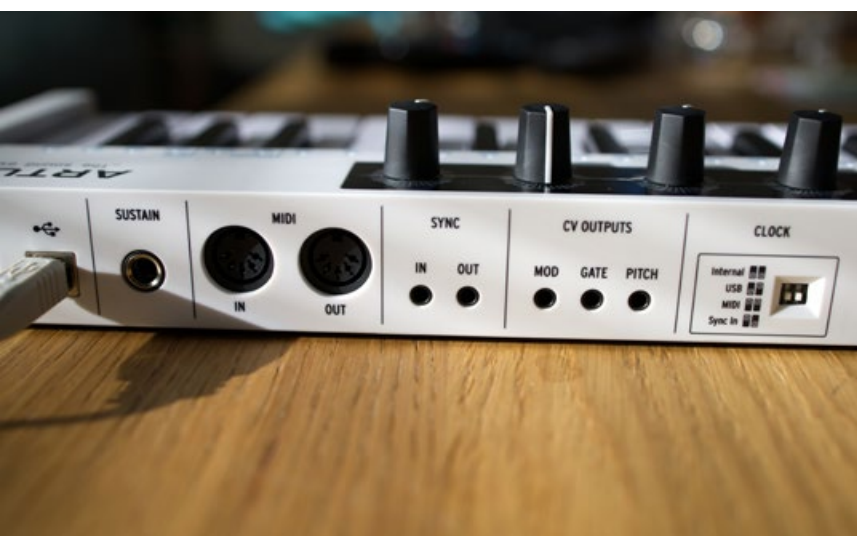
Hinten sind die Anschlüsse: Einer für ein Sustain-Pedal, MIDI I/O, USB-B-Buchse, Sync I/O, CV Outputs (Gate, Pitch, Mod) und Switches für die Clock-Konfiguration.
