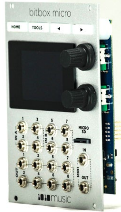
bitbox und bitbox micro sind Sample-, Slicing- und Granularsynthese-Module für das Eurorack mit Touchscreen, endlosem Disk-Streaming, MIDI-, Audio- und CV-Anschlüssen. Die integrierten Features wie Spielbarkeit via Touchscreen, Konnektivität, Polyphonie und Multitimbralität, FX, integrierter Mixer, Recorder, Multisampling erweitern die musikalischen Möglichkeiten im Eurorack-System auf ganz besondere Weise.
