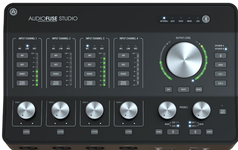
Moderne Studiozentrale: Das AudioFuse Studio ist als Desktop-Interface konzipiert, passt dabei aber dennoch in Jeden Rucksack. Die Oberfläche bietet u.A. vier Input-Channels mit DiscretePro-Vorverstärkern sowie eigener Kontrollsektion.
