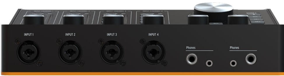
Auf der Frontseite stehen neben den vier Combo-Anschlüssen für die Eingangskanäle eins bis vier (XLR/Klinke 6,3mm), auch je zwei Kopfhörerausgänge pro Kopfhörerverstärker bereit. Jeder Ausgang bietet sowohl einen 6,3mm- als auch einen 3,5-mm-Kopfhörerausgang.
